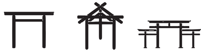
GEKU TORII 外宮鳥居 MIHASHIRA TORII 三柱鳥居 MIWA TORII 三輪鳥居
