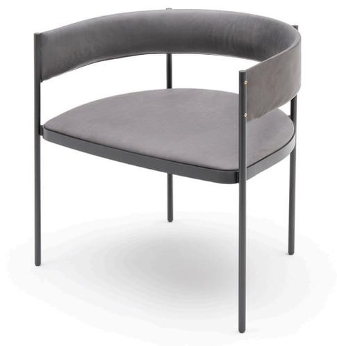
Easychair costituita da gambe in tondo d'acciaio sezione  $\varnothing 16$  mm legate tra loro tramite un anello sagomato in lamiera d'acciaio sp.4 mm, tagliato a laser in un unico pezzo, a cui è saldato un piatto di acciaio sezione 30x4 mm, trafilato e calandrato che funge da telaio sedile; sedile in multistrati di pioppo con molleggio a nastri elastici intrecciati in caucciù rivestito, con imbottitura in poliuretano espanso, rivestita con falde di fibre acriliche.
